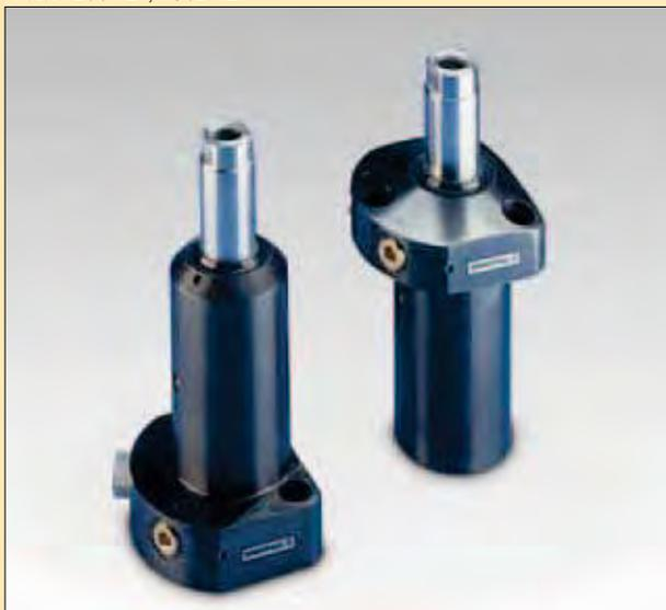
▶ Los cilindros de tracción hidráulica utilizan presión hidráulica para sujetar piezas en un dispositivo. El émbolo dirigido conserva la orientación durante todo el ciclo de sujeción y así elimina la necesidad de una guía externa. Los extremos del émbolo con rosca interior son compatibles con varios acoplamientos a medida, lo cual facilita el proceso de sujeción.
